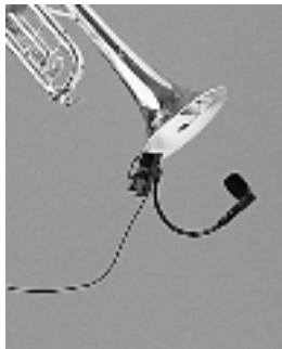
INSTALLAZIONE SU TROMBA FIGURA 7
