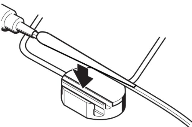
Bitte befestigen Sie den Microfonarm so, dass die Metallplatte nach oben zeigt (siehe Abb.).
