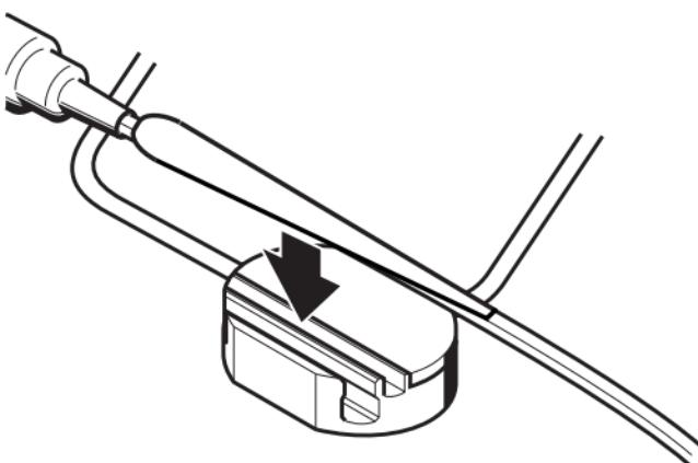
Fissare il braccio del microfono con la piastra metallica rivolta verso l'alto (vedere fig.).
