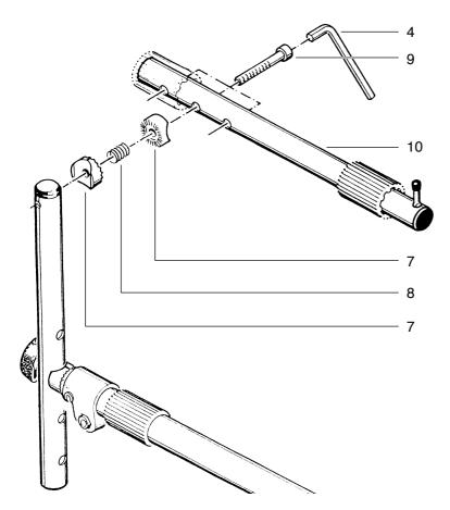
Auflagerohr 10 in gewünschter Position mittels Innensechskantschraube 9, Rastscheiben 7 (2 Stück) und Feder 8 mit Innensechskantschlüssel 4 an Verbindungsrohr befestigen- siehe Abb. Gummiauflagen dem Instrument anpassen. To assemble horizontal brace 10 and vertical support arm 5, align parts in sequence as illustrated and tighten- see drawing.
