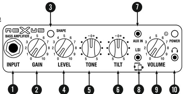
7- 音频输入: 可连接3.5mm的立体声输入来播放例如手机，MP3和CD播放器的音频，可用于播放伴奏音轨。该输入的音量控制可以通过您的手机，MP3或CD播放器来控制，或者使用VOLUME旋钮控制
