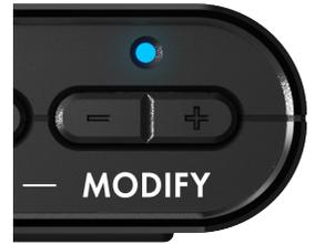
Um einen reinen Verstärker-Sound ohne vorhandenen Effekt zu erzielen, verfügt das Gerät über eine MODIFY-Effekt-Bypass-Einstellung (---).
