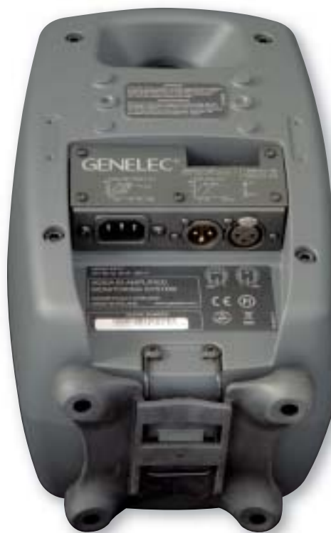
Gut erkennbar ist hier der sogenannte Iso-Pod-Standfuß, der die Neigung der 8030A zum Hörer gestattet und der akustischen Entkopplung vom Untergrund dient.
